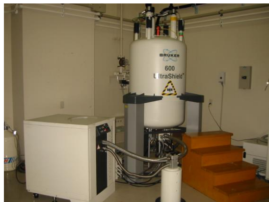
He冷却超高感度 600 MHz NMR
