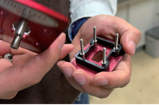
2枚の鏡をセットするセル。ネジを締めて距離を調節する。
