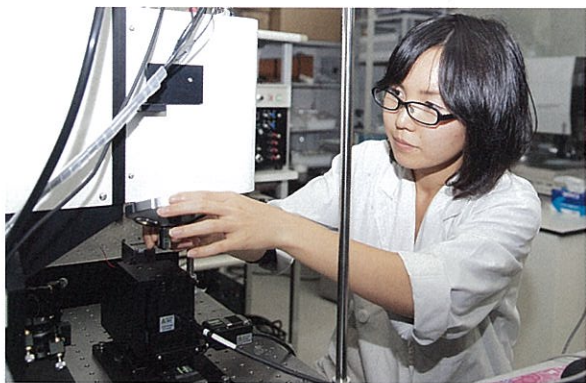
偏光ラマン計測装置を操作する長澤文嘉(ながさわふみか)さん(博士課程2年)。物質に光を当て分子・原子レベルでその反応を測定する。
